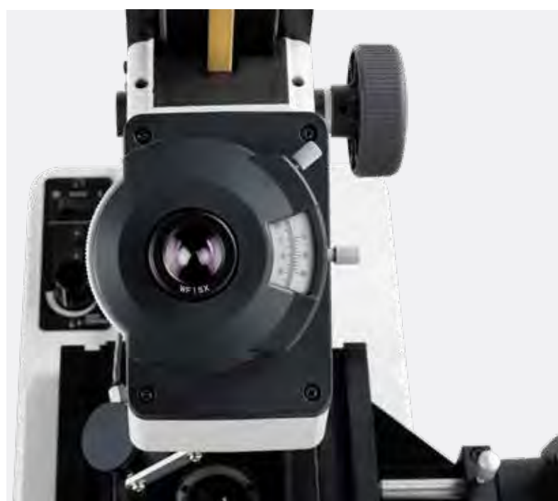
Noniusz zamontowany na zewnątrz okularu umożliwia łatwy pomiar kąta.
