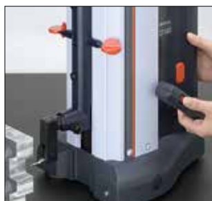
LH-600EG Przycisk do włączenia poduszek powietrznych znajduje się na ergonomicznym uchwycie.
