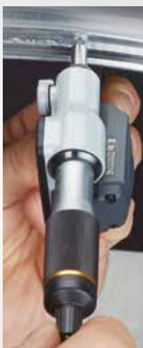
U-WAVE-T podłączony do czujnika Digimatic specjalnym kablem kompatybilnym z interfejsem danych określonego czujnika.
