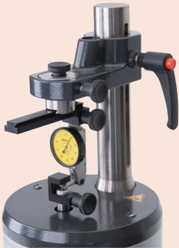
Wzorcowanie czujnika dźwigniowo-zębatego z dodatkowym wyposażeniem
