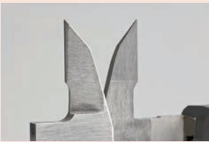
Powierzchnie pomiarowe szczęk z węgla spiekanego
