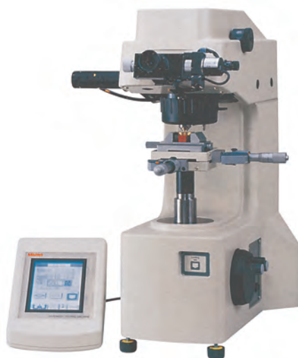
HM-112 Cyfrowe wyświetlanie wyników pomiaru i funkcja obliczeń statystycznych
