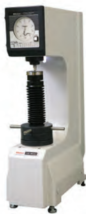
HR-210MR Twardościomierz Rockwella Ręczne ustalanie obciążenia i przyłożenie nacisku wstępnego. Motoryczna sekwencja obciążania.
