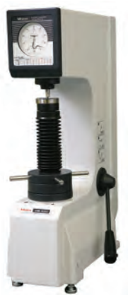
HR-110MR Twardościomierz Rockwella Przyjazny dla środowiska model niewymagający zewnętrznego zasilania. Podstawowe operacje wykonywane są ręcznie, łącznie ze zmianą obciążenia (ustawianie obciążenia całkowitego).
