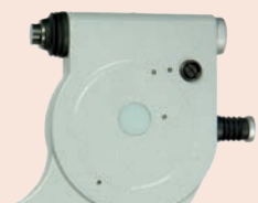
Śruba do regulacji mikrometru \pm 5 \mu m
