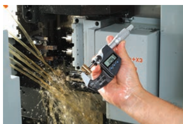
Doskonała odporność na wodę i pył (IP65)
