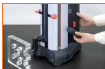
LH-600EG Konstrukcja z uchwytem. Przycisk do aktywacji poduszki powietrznej zamontowany fabrycznie w uchwycie ręcznym.
