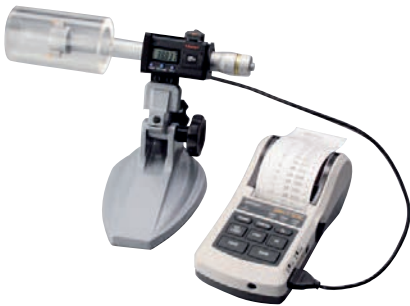
Średnicówka trójpunktowa z opcjonalnym wyposażeniem Statyw 156-101-10 Drukarka DP1-VA 264-505D Uchwyt 04AZB157 Kabel 05CZA662
