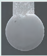
UMAP 107 ø70 µm L = 5 mm
