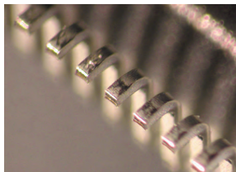
Przykład pomiaru : Wysokość wyprowadzeń obudowy QFP
