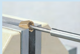
Kształt gwintu wewnętrznego
