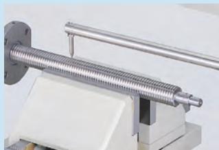
Kształt gwintu zewnętrznego
