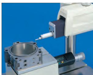
Pomiar w głębokim rowku
