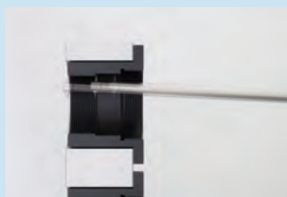
Podwójna końcówka do pomiarów z igłą skierowaną w dół i do góry
