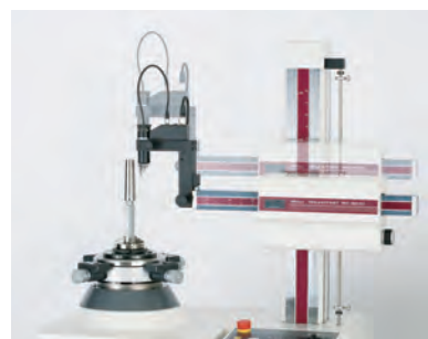
Pomiar z wykorzystaniem przemieszczenia w osi X
