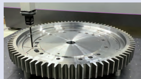
Skanowanie sondą SP80 z końcówką 100 mm.
